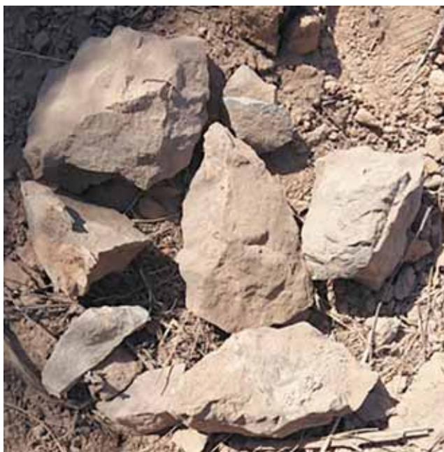
▲ Рис. 6. Камень после сгорания газогенераторного состава \text{NH}_4\text{NO}_3 – 80 %, С – 15 %, Al – 5 %
