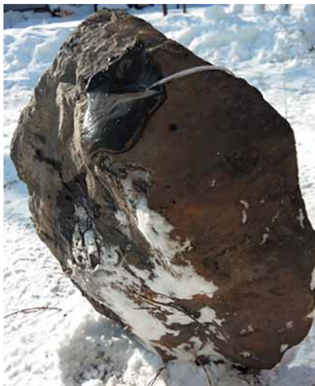
▲ Рис. 5. Камень, заряженный зарядом газогенераторного состава \text{NH}_4\text{NO}_3 – 80 %, С – 15 %, Al – 5 %
